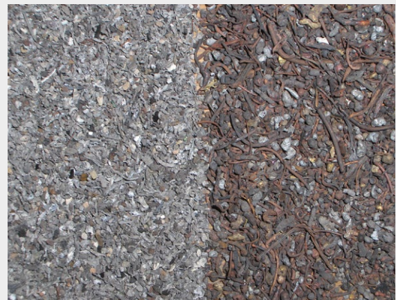
Metalle und Mineralien für das Recycling, die aus Schlacke zurückgewonnen werden
